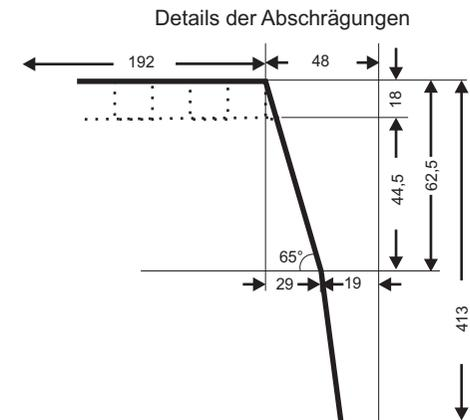
Alle Aussenkanten werden mit r=12 rundgefräst.
