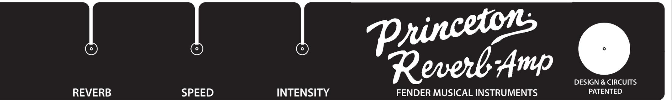
Diese Vorlage ist im Masstab 1:1 und kann als Bohrschablone für die Frontplatte verwendet werden
